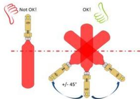
Senkrechte Montage mit Auslösekopf nach unten. Max. Drehwinkel +/- 45°
